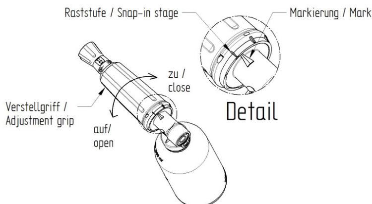
Durch Drehen am Verstellgriff kann die Menge an zugeführtem Schaummittelkonzentrat eingestellt werden. Insgesamt besitzt die Schaumlanze ST-73 fünf Raststufen zur festen Positionierung der Dosiereinstellung, diese sind beim Drehen des Verstellgriffs leicht bemerkbar.
