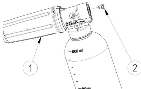
1. Drehen Sie die Injektordüse (Pos. 1) aus der Schaumlanze ST-73 (Pos. 2)
