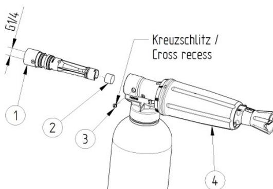
1. Lösen Sie die Arretierungsschraube (Pos. 3) mit einem Kreuzschlitzschraubendreher.
