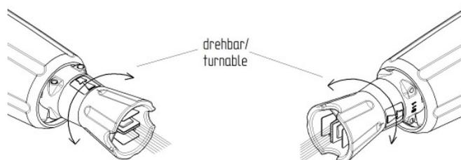
Die Flachstahldüse am Ausgang der Schaumlanze ST-73 ist in jede Position drehbar. Sie müssen hierzu nur den Düsenschutz in die gewünschte Richtung drehen.
