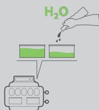
L'humidité est nécessaire au bon fonctionnement de la couveuse. Le niveau d'eau dans les bassines doit être vérifié et complété tous les deux jours.
